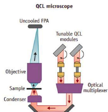
**Applications :** Particulièrement bien adapté pour l'analyse des microplastiques | Imagerie biomédicale des tissus | Essais pharmaceutiques | Analyses de protéines | Surveillance de réaction en temps réel | Polymères | Inspection | Essais et analyse de matériaux.
